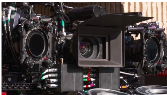
сурет 1 – The Irishman киносында қолданылған үш-камералы құрылғы. Фотосурет авторы Нико Тавернис (Niko Tavernise) – Netflix.
