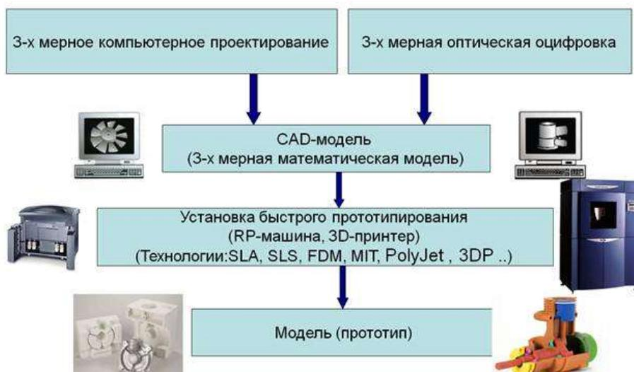
Рисунок 1 - Технология быстрогопрототипирования (RapidPrototyping)
