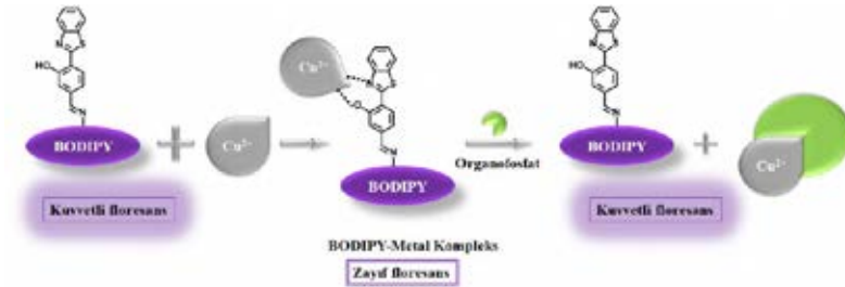
Şekil 1. Organofosfatların tespiti için geliştirilen sensör mekanizması.
