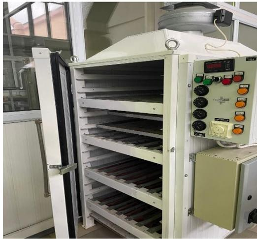
Fig.1. «Universal-SD-4» infrared drying cabinet
