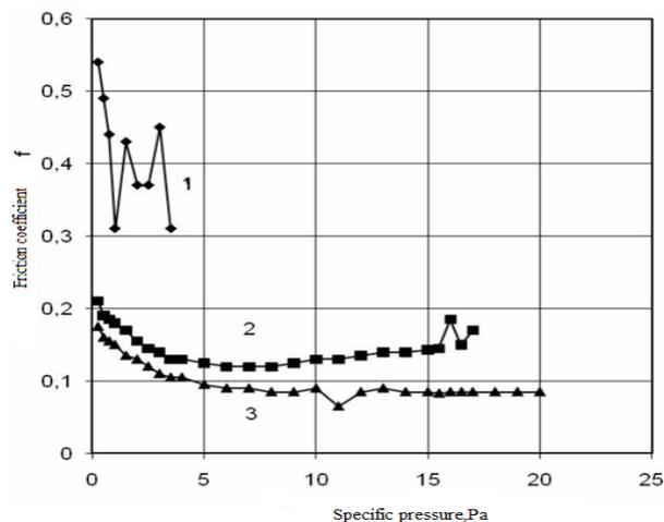
1 - quenching 1150 ° C, 2 - nitriding 620 ° C, 35 h, 3 - carbonitriding 570 ° C, 12 h
