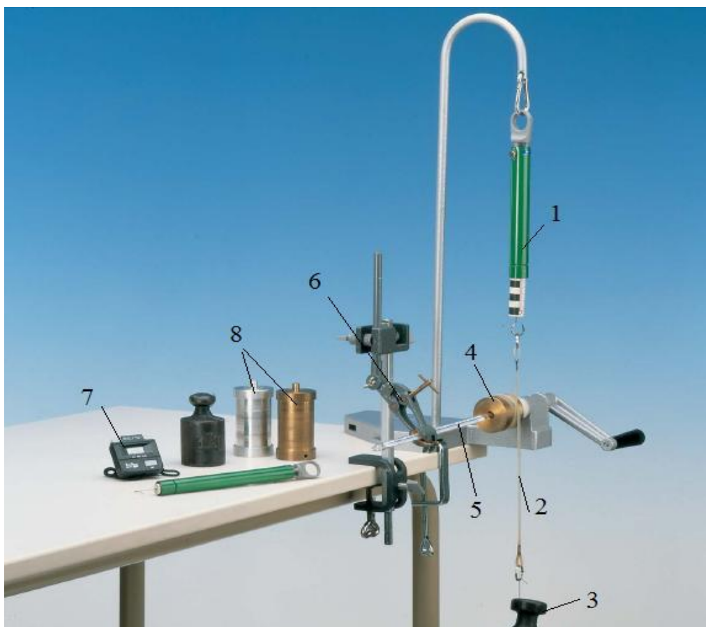
1- динамометр, 2 - пластмассовая лента, 3 - гиря; 4 – исследуемый цилиндр, 5 - термометр или электронный датчик температуры, 6 - универсальный зажим; 7 – секундомер, 8 - дополнительные цилиндры.
