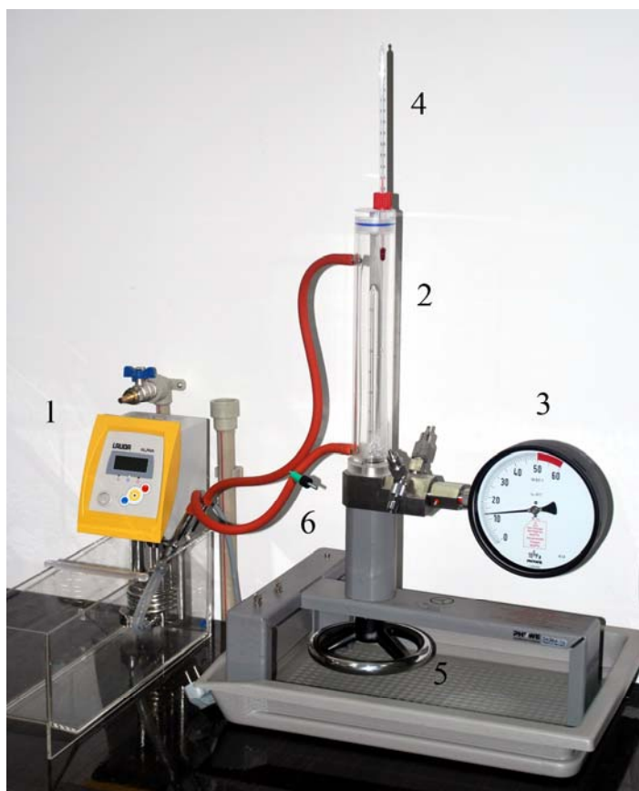
1 – термостат, 2 – колба, 3 – манометр, 4 – термометр, 5 – маховик, 6 – зажим.
