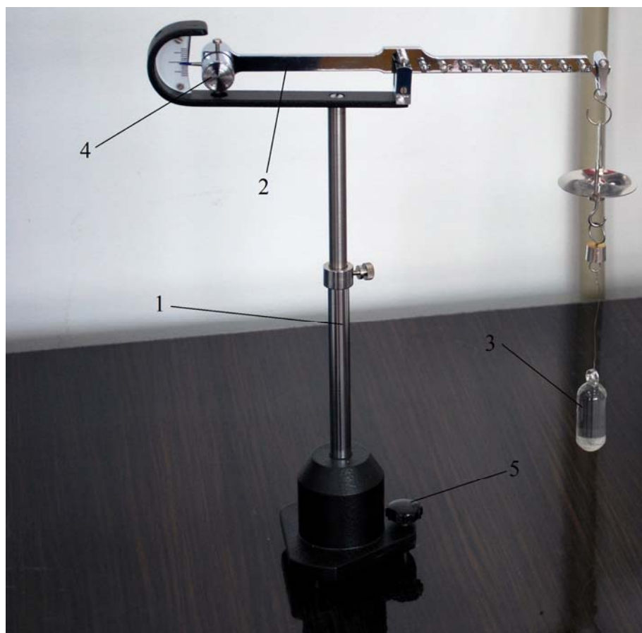
1 – подставка, 2 – коромысло с указателем, 3 – стеклянный поплавок, 4 - постоянный груз, 5 – регулировочный винт.
