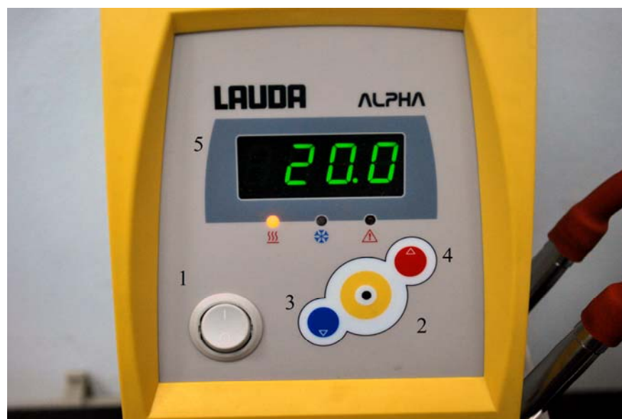
1 – кнопка включения и выключения, 2 – кнопка установления режима, 3 – кнопка уменьшения температуры, 4 – кнопка увеличения температуры, 5 – табло индикации.
