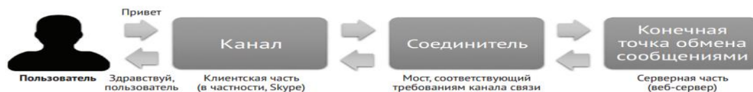
Рисунок 1 - Схема архитектуры приложения с разговорным интерфейсом на основе инфраструктуры Bot Framework
