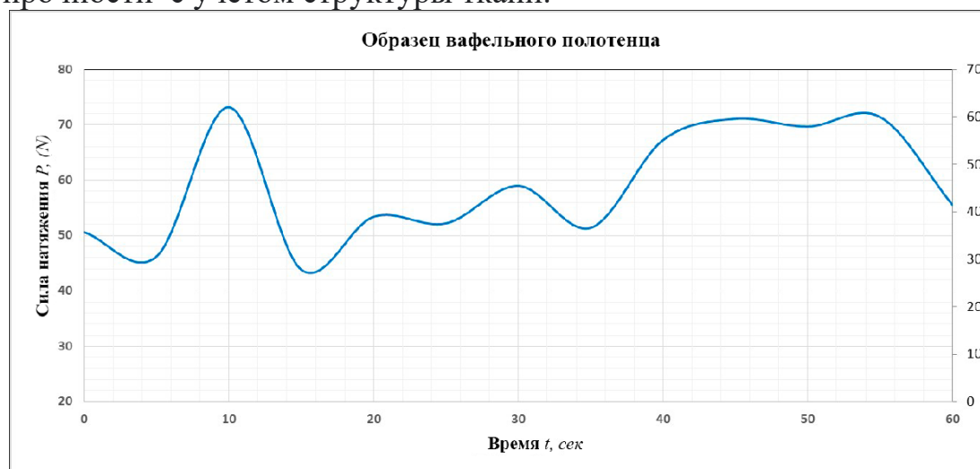
Рис. 1. Осциллограмма натяжения нити при производстве полотенчатых тканей.
