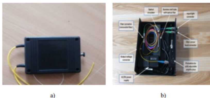
Рисунок 2. Волоконно-оптический датчик для контроля состояния инженерных и строительных конструкций а) натурная модель; б) внутренность датчика
