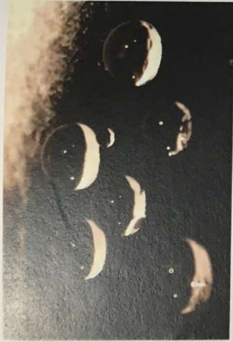
Рис. 2. Поведение капли воды на полученной сажевой поверхности при расстоянии сбора 2,5 см от начала фронта пламени
