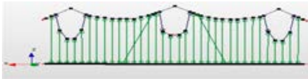
Рис. 8. Модель цепной контактной подвески с промежуточными оттяжками
