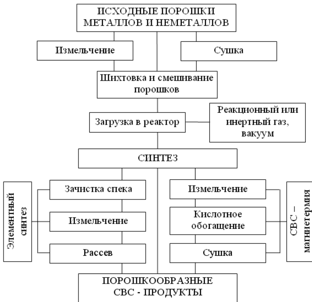
Рис 35 Схема СВС–технологии производства порошков
