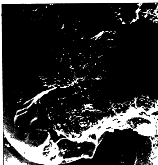
Рис.6б. Капиллярное растекание (впитывание) в системе Ti-C: зона реакции
