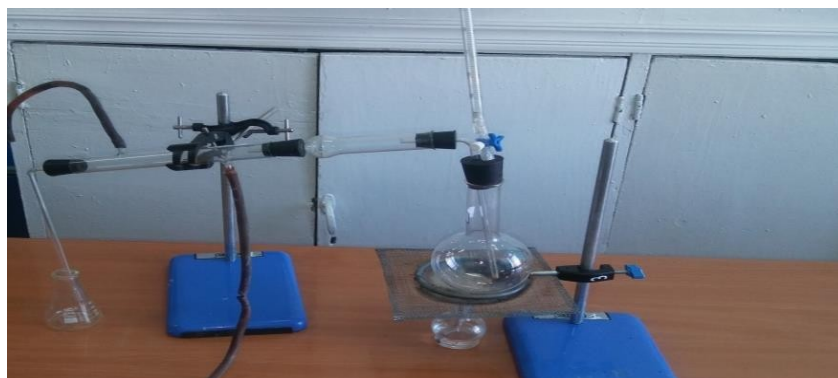
Сурет 4 - Эрленмейер колбасымен және қосымша құрылғылардың құрылысы
