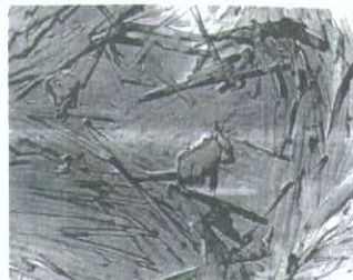
Рисунок 2. Микроснимок структуры монтмориллонита[4].
