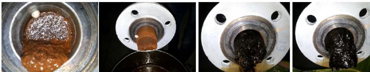
Рисунок 2 – Удаление механических примесей, ржавчины и АСПО из модельного нефтепровода композиционным полимерным гидрогелем «ПИГ-1»
