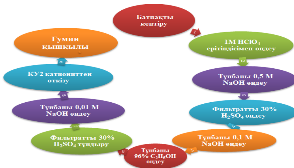
1 сурет. Азминералды лай сульфидті батпақтан гуминдік заттарды бөліп алудың принципіалды сызбанұсқасы.
