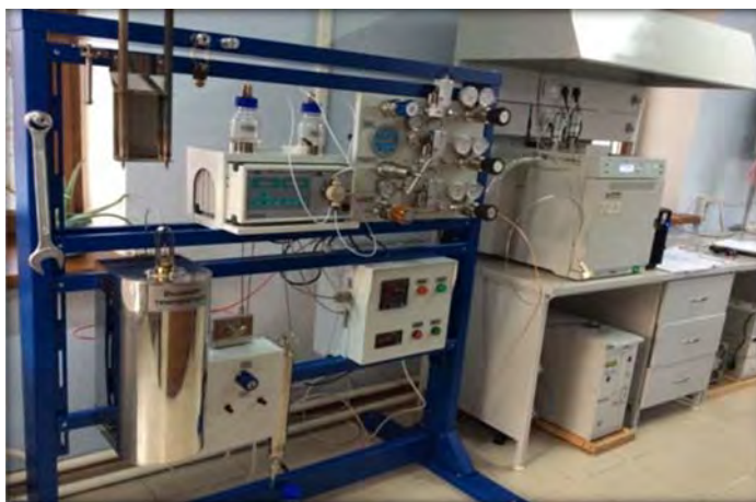
Рисунок 1 - Проточная каталитическая установка под высоким давлением (ПКУ -2ВД)
