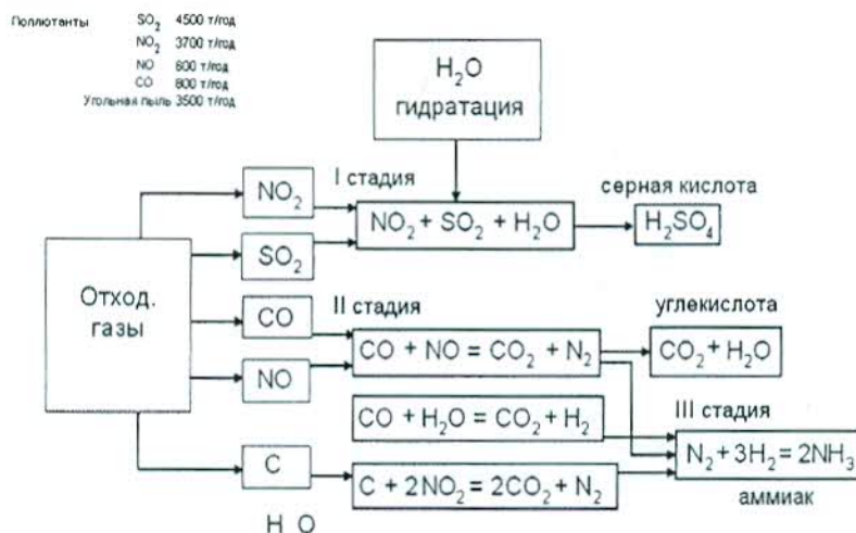
Принципиальная схема утилизации отходящих газов в серную кислоту (I стадия), углекислоту (II стадия) и аммиак (III стадия)
