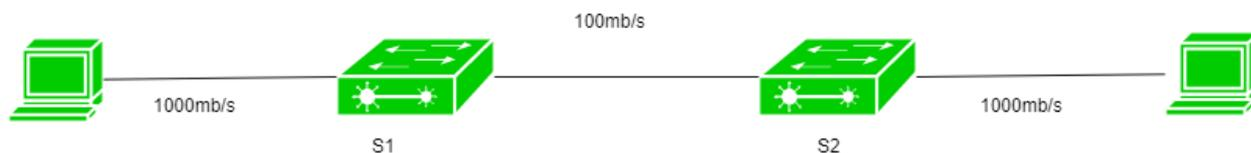
Рис. 3. Топология сети с использованием одного канала
