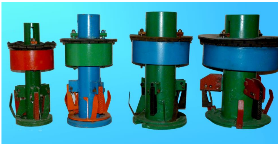
Рисунок 2 - Устройство (манжета) для откачки воды по обсадной колонне скважины различных диаметров
