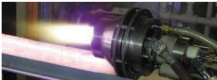
Рисунок 1 – Высокоточный плазматрон постоянного тока
