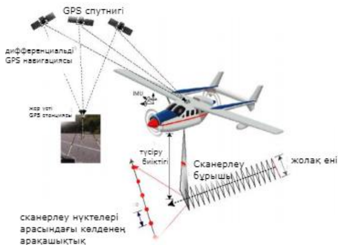
Сурет 3- Әуе лазерлік-лакациялық түсірістің принципі
