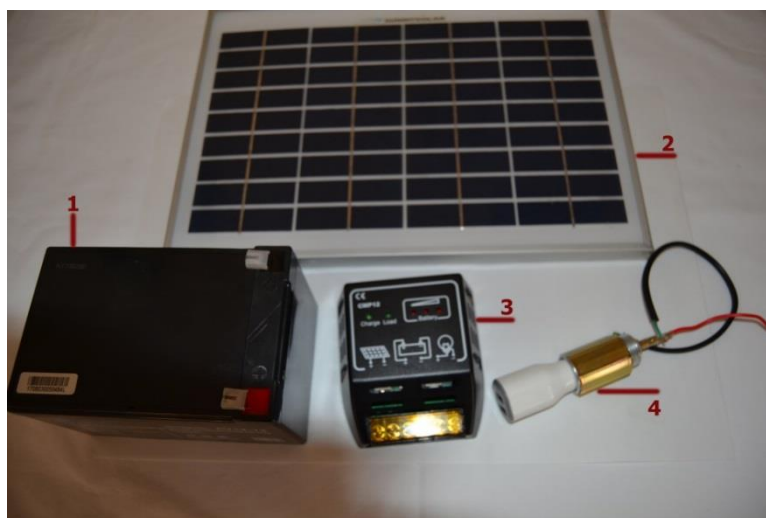
Рис. 3. Автономный блок энергообеспечения: 1 – Аккумуляторная батарея (МНВ); 2 – Солнечная панель; 3 – Контроллер заряда для солнечной батареи; 4 – автомобильное зарядное устройство, обеспечивающее током 5в.
