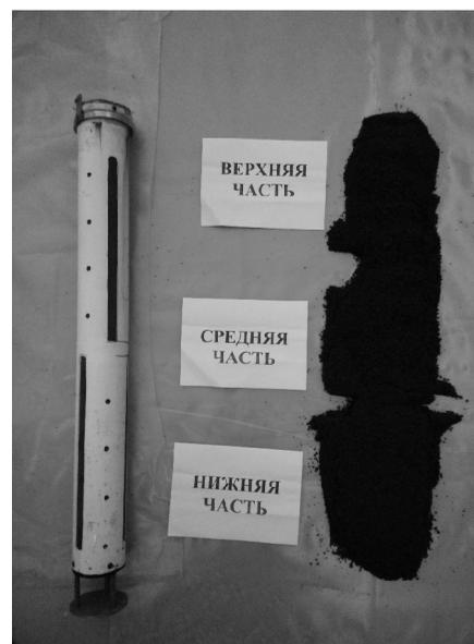
**Рис. 5.** Погружное устройство и сорбент.
