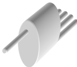
Рисунок 1. 3D модель эллипсоидального демультимплексора
