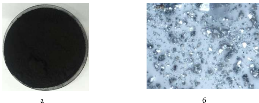
Рисунок 2 – Общий вид порошка карбонизированной РШ (а) и оптическая фотография (б)
