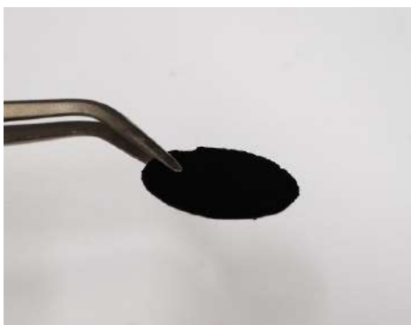
Рисунок 1. Фотография гибридного электрода на основе активированного углерода и углеродных нанотрубок
