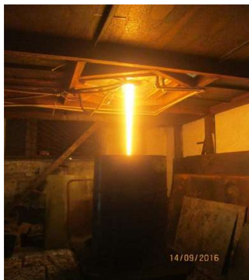
Рис 1. Электромагнитный реактор и струя расплава базальта, вытекающая из него
