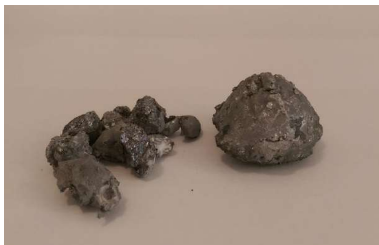
Рисунок 1 – Королек, полученный после 15-ти минутной механоактивации (кварцевый песок + алюминий)
