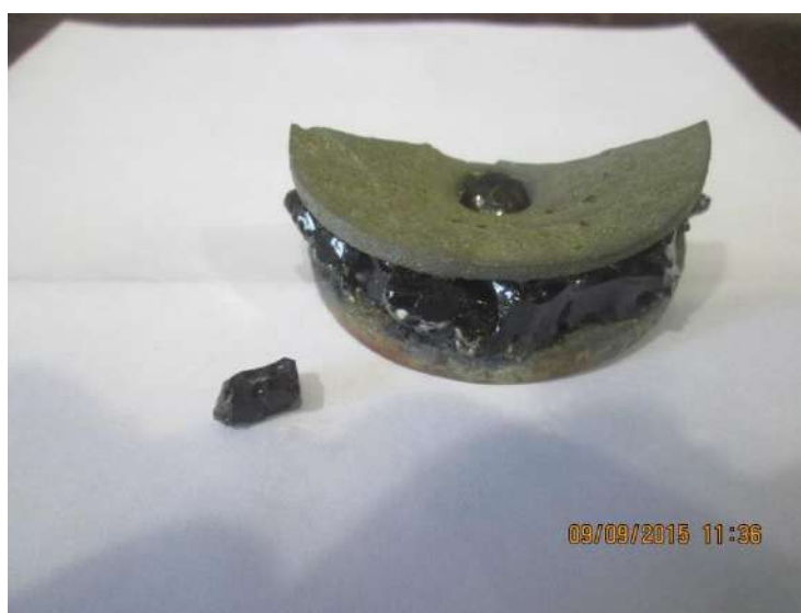
Рис. 2 Образец лётки из нитрида кремния, проработавшей 8 часов.
