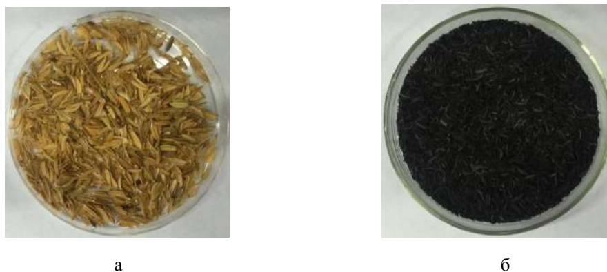
Рисунок 1 – Общий вид рисовой шелухи до карбонизации (а) и после карбонизации (б)
