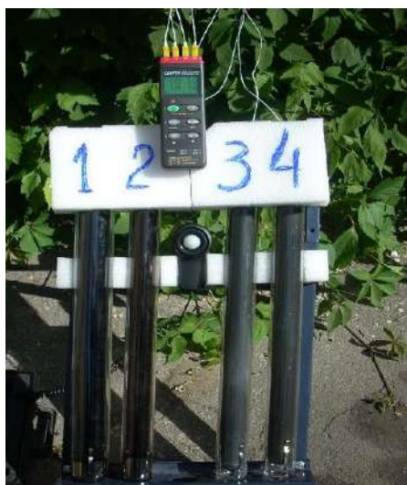
Рисунок 3 – Фотографии общего вида солнечных коллекторов в процессе испытания в реальных условиях: 1 – коллектор фирмы Apricus, 2 – коллектор ПП (Китай), 3 – коллектор с РШ2, 4 – коллектор с РШ3
