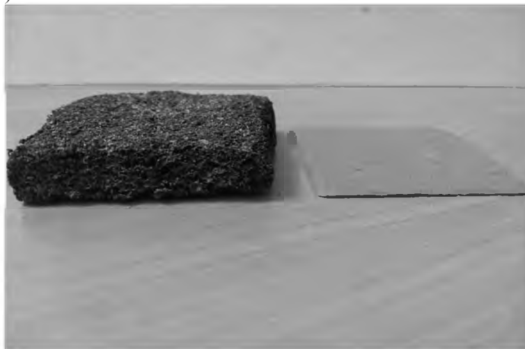
Рис.1. Исходный (справа) и после огневого воздействия (слева) силиконовый огнестойкий герметик (Т=340 °С, 3 часа)
