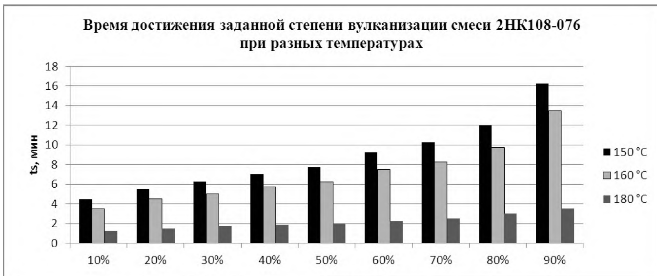
Рис. 2. Время достижения заданной степени вулканизации при разных температурах для смеси 2НК108-076.
