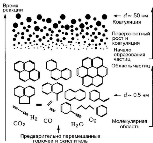
Рис. 2. Схематическое изображение процесса сажеобразования в гомогенных системах или в пламенах предварительно перемешанной смеси [19]
