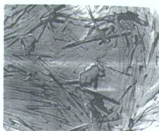
Рисунок 2. Микроснимок структуры монтмориллонита [4].
