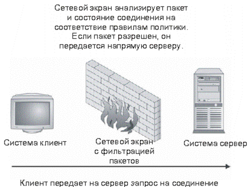
Рис. 10.2. Передача трафика через межсетевой экран с фильтрацией пакетов
