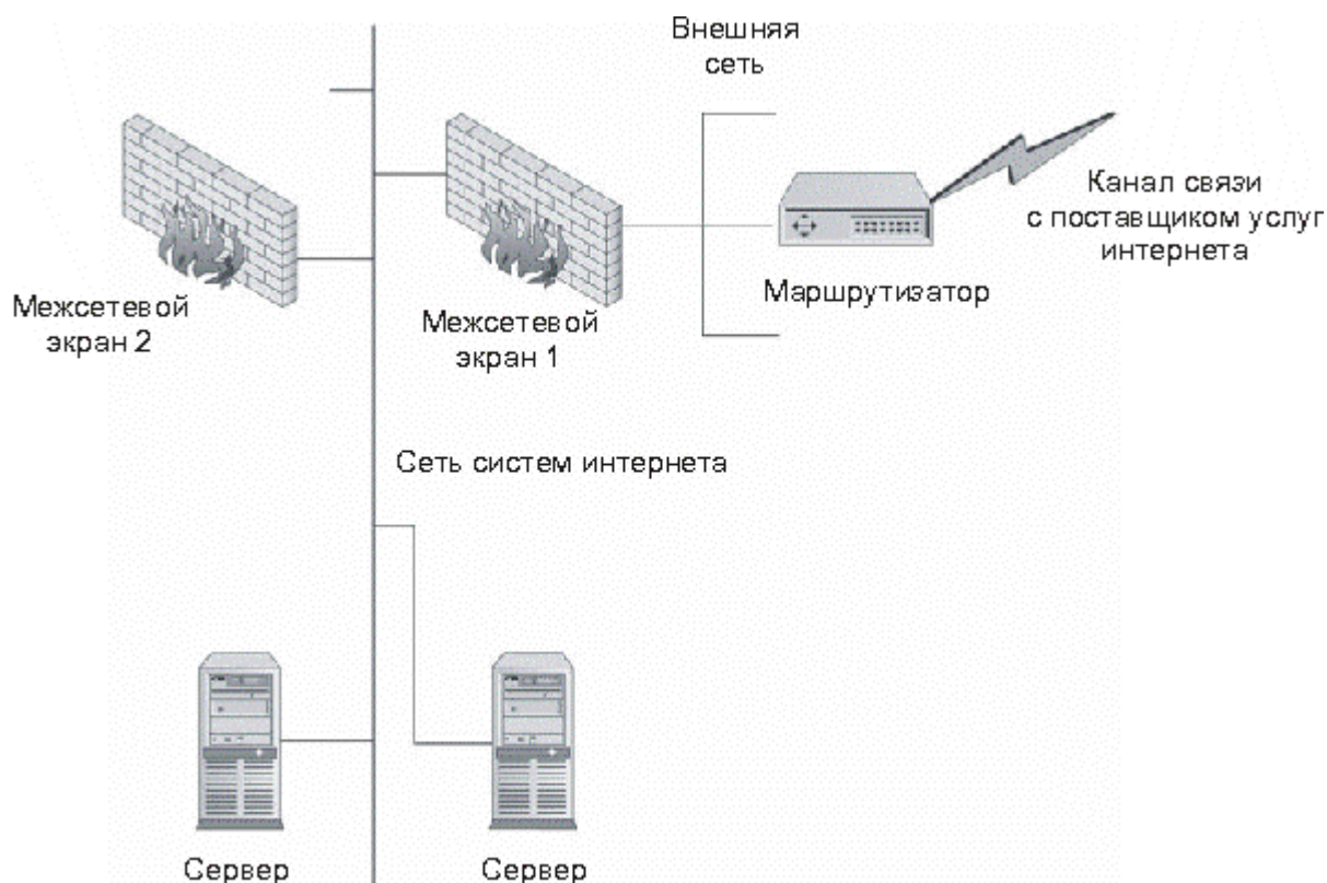
Рис. 10.5. Архитектура 3: двойные межсетевые экраны
