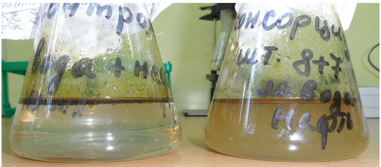
Рисунок 4 - Эксперимент на убыль нефти в морской воде: а - контроль, б - консорциум штаммов Bacillus sp. 13 и Acinetobacter sp. 10
