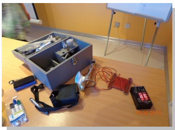
Сурет 3. Электронды түрленуші зырылдауық ИСВП (ағыс жылдамдығын өлшеуіш).
