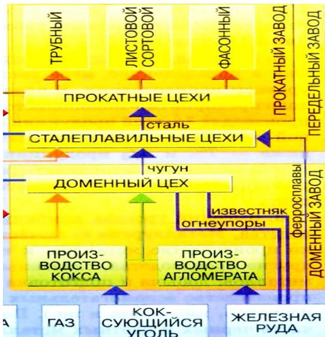
Рисунок 3. Комбинат (завод) полного металлургического цикла
