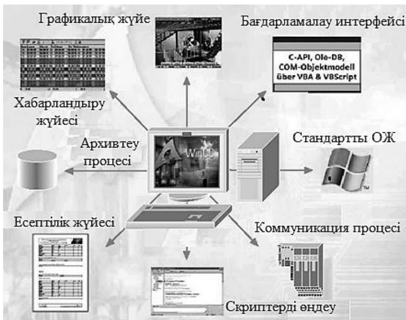
Сурет 3. WinCC ішкі жүйелерінің өзара әрекеттесуі
