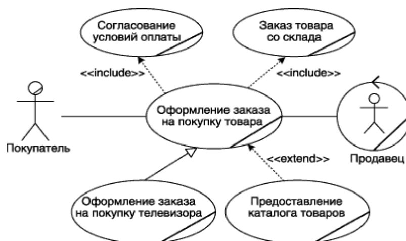
3.8-сурет – UML тілінің ортақ белгілеулерінде каталог бойынша тауарларды сату жүйесі үшін қолдану нұсқасының диаграммасы
