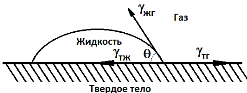
Рисунок 3. Капля жидкости, находящаяся в равновесии с твердой подложкой, \theta - краевой угол смачивания; \gamma_{тг} , \gamma_{тж} , \gamma_{жг} , - поверхностная энергия контакта «твердое тело – газ», «жидкость – газ» и «твердое тело – жидкость» соответственно.
