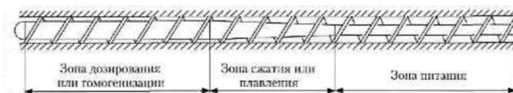
Рисунок 22. Разделение шнека на три стадии технологического процесса.
