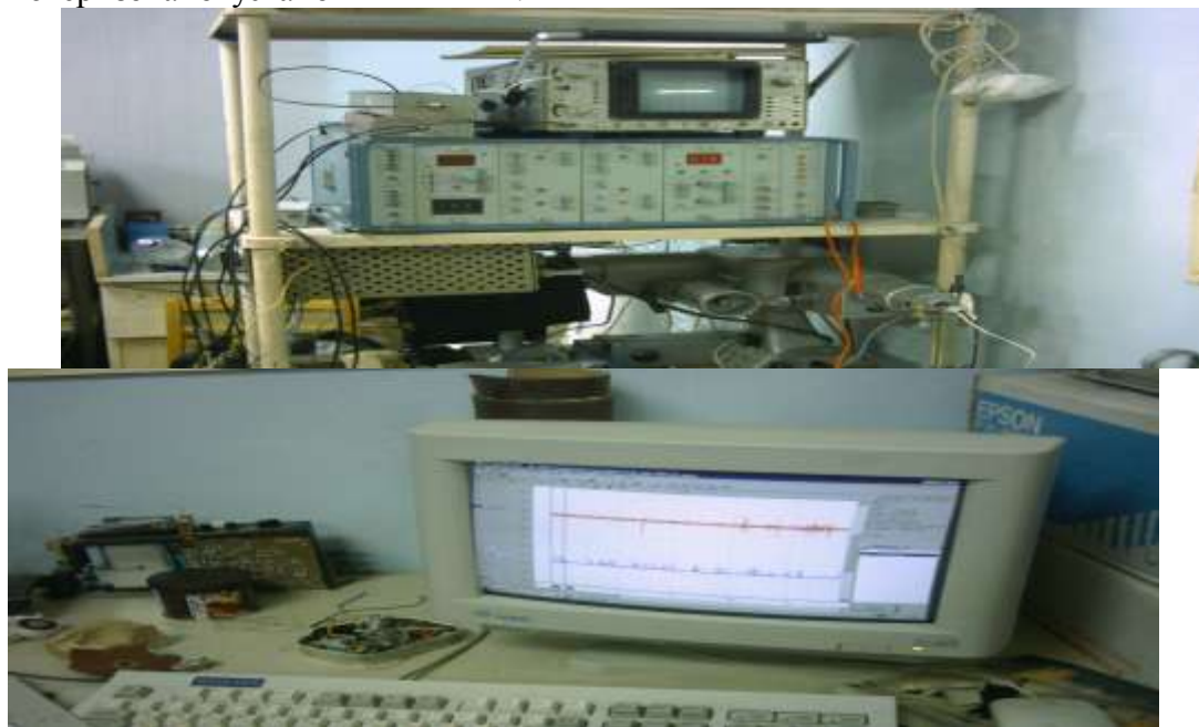
Рис. 3. Установка методики акустичної емісії (АЕ) на частоті f_{\parallel} = 0,200 \div 0,500 МГц \alpha = 70 дБ для вимірювання швидкостей пружних хвиль зразків гірських порід.
