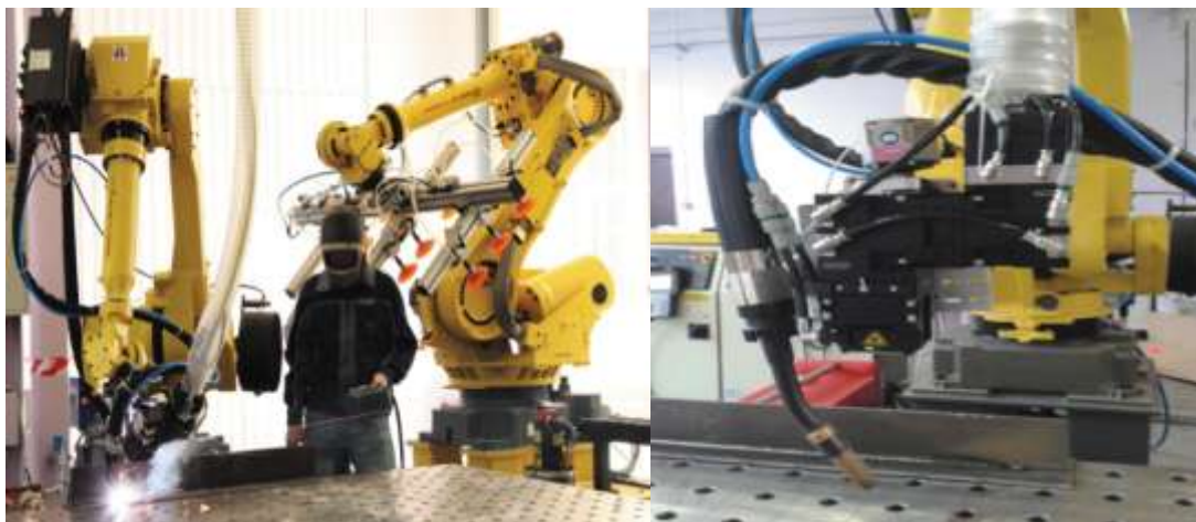
Рис. 2. Роботизований комплекс для гібридного лазерно-дугового зварювання суднових мікропанелей
