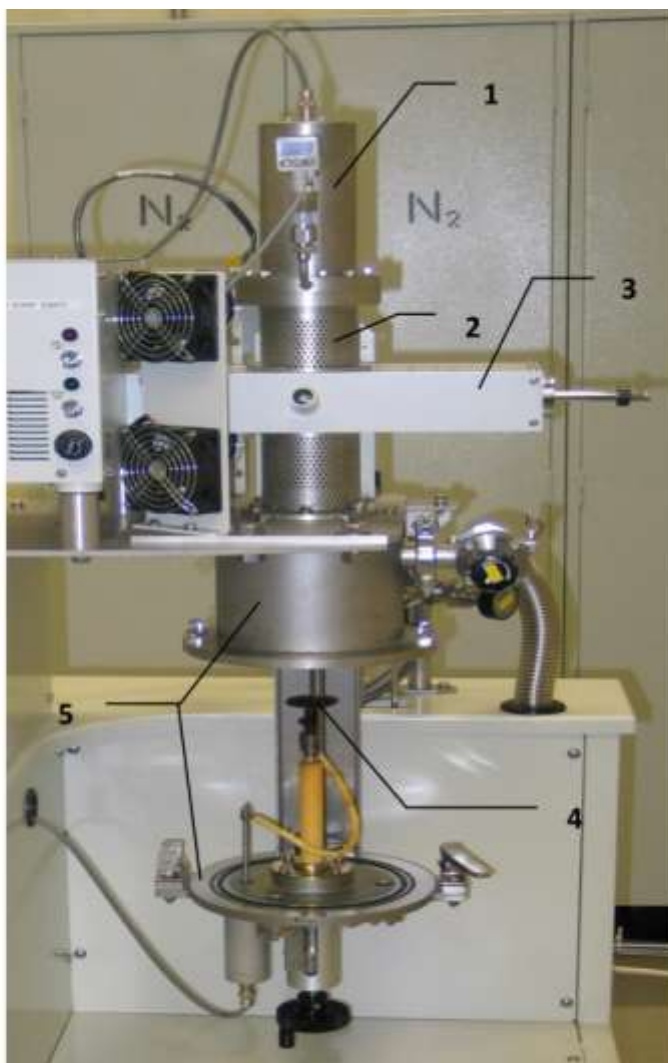
1 – верхний электрод; 2 – расположение ростовой камеры; 3 – волновод; 4 - подложкодержатель, выполняющий роль нижнего электрода; 5 - загрузочная камера
