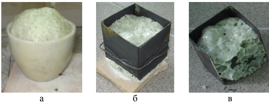
а) пеностекло в тигле; б) пеностекло в металлической форме; в) пеностекло в разрезе Рисунок 4 – Лабораторные образцы пеностекла
