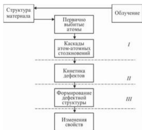
Рисунок 18.1.Схема основных стадий радиационной повреждаемости материалов:
