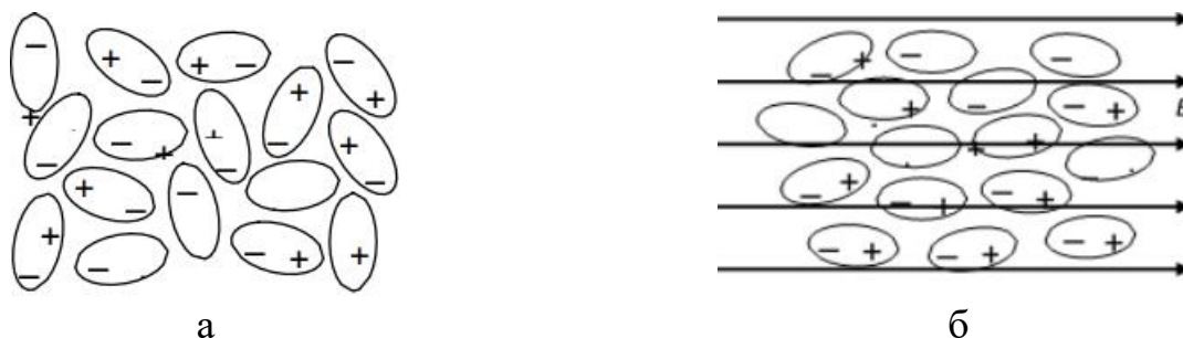
Рисунок 17.6 Расположение дипольных молекул без поля (а) и при наложении электрического поля (б)
