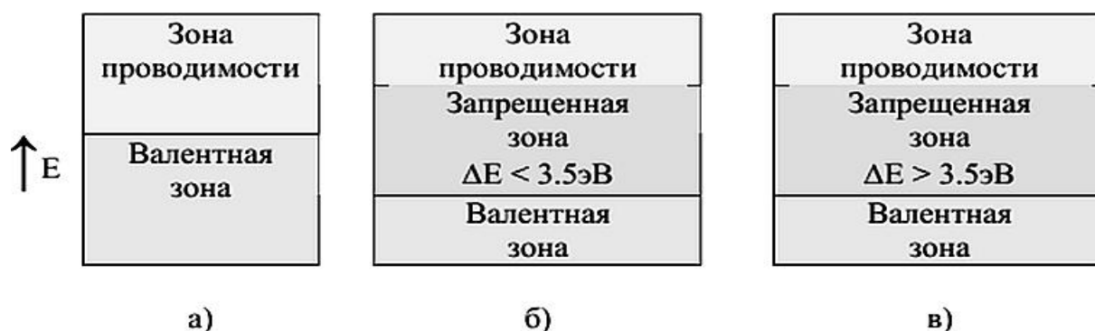
Рисунок 1.2. Структура энергетических зон в проводниках (а), полупроводниках (б) и диэлектриках (в)
