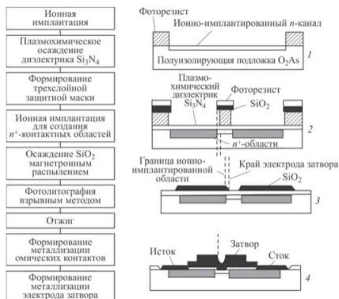
Рис. 6.3. Последовательность операций изготовления транзистора на GaAs с самосогласованным затвором и ионно-имплантированными слоями n -типа. 1 – формирование n -слоя ионной имплантацией; 2 – формирование рисунка по трёхслойной защитной маске и ионная имплантация для создания n -областей; 3 – снятие методом взрывной литографии напылённого \text{SiO}_2 ; 4 – формирование металлизации и электродов.
