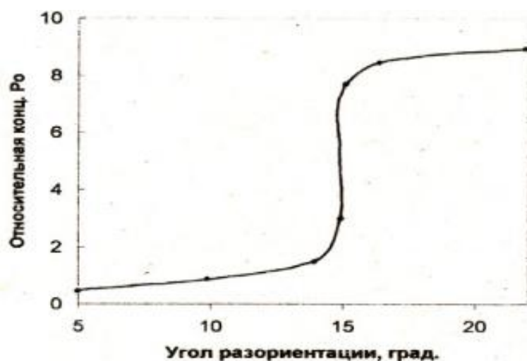
Рисунок 5.11 Сегрегация примеси полония по границам блоков в кристаллах сплава свинец – висмут
