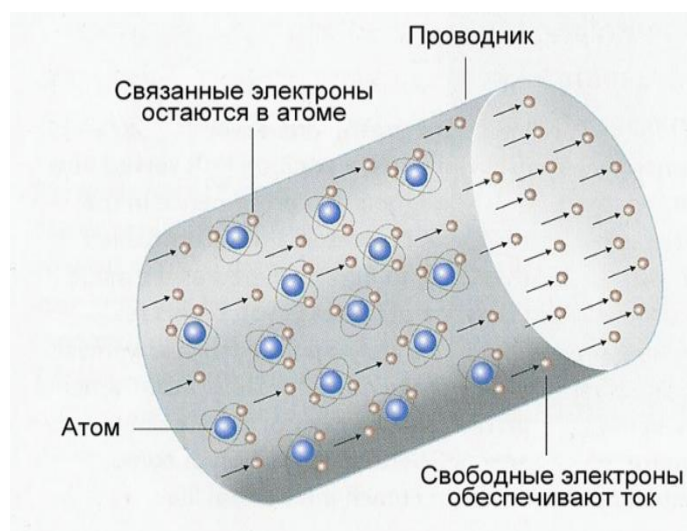
Рисунок 1.1. Проявление электронной проводимости в металле.
