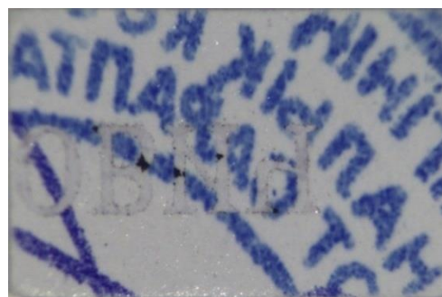
Фото №12. То же, что и на фото №11 после копирования на ПВХ-пленку, размягченную в циклогексаноне, контакт 2 секунды.
