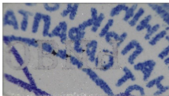
Фото №17. Места пересечения оттиска печати, чернил роллерной ручки и печатного текста. Фото №18. То же, что и на фото №17 после копирования на ПВХ-пленку, размягченную в циклогексаноне, контакт 2 секунды.
