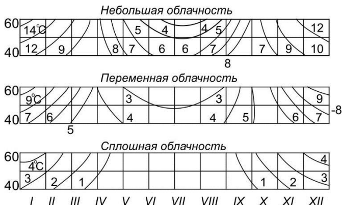
3.2 сурет. 40 – 60° ендіктерде айлар бойынша бұлттылыққа түзету графигі ( \Delta T_{min} )
