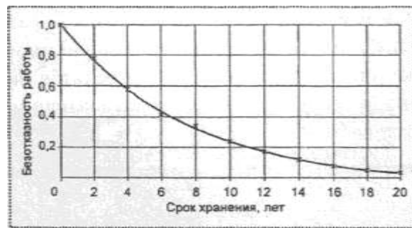
Рисунок 2 – Изменение безотказности работы ВВТ после различных сроков хранения
