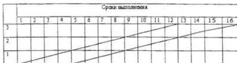
**Рисунок 6.12.** Равноритмичная циклограмма
