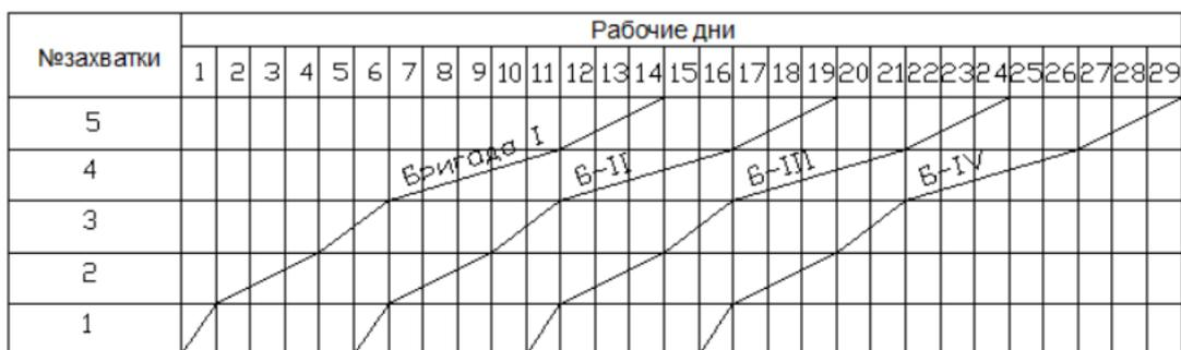
**Рисунок 6.13.** Циклограмма неритмичного потока
