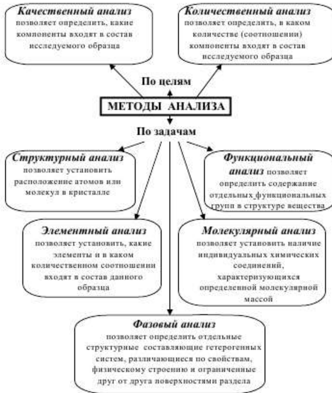
Рисунок 1.5 – Схема классификации аналитических методов по целям и решаемым задачам
