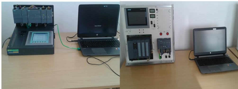
Рисунок 3 – Лабораторные стенды фирмы SIEMENS на базе SIMATIC S7-1200 с HMI, SIMATIC S7-1500 с HMI и SCADA-системы на базе WinCC
