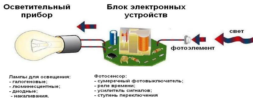
Рисунок 4 – Принцип работы фотоэлемента.
