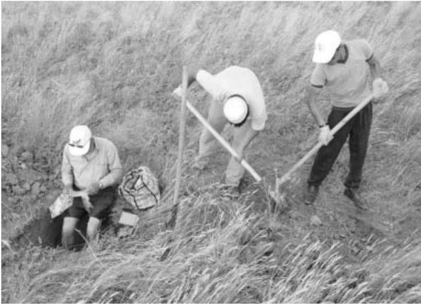
Рис. 1. Копка и фиксация шурфов
