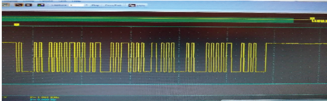
Рисунок 3. Оциллограммой снятый сигнал передачи ESP8266.
