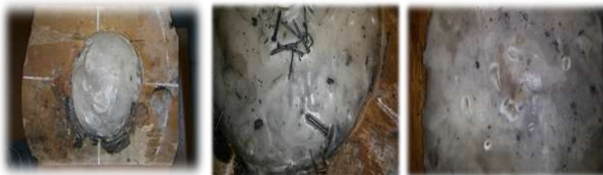
Рисунок 1– Мишени после выстрелов с частичным и полным проникновением
