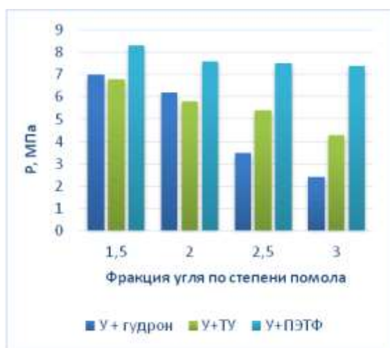
Рисунок 2 – Влияние степени помола угля на прочность брикетов, МПа
