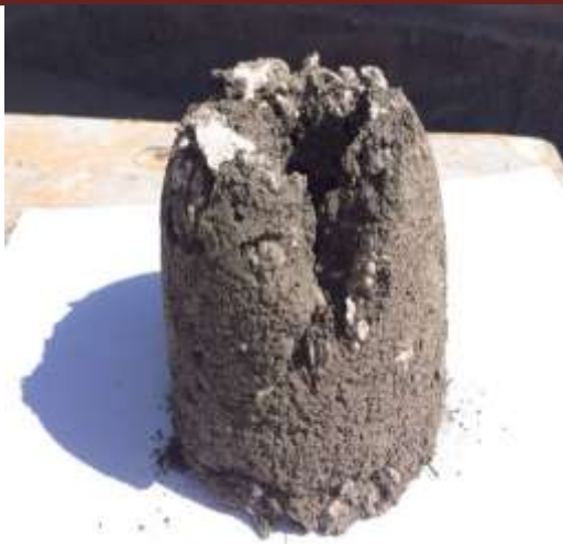
Рисунок 1 – Брикет конусообразной формы с воздушным каналом.
