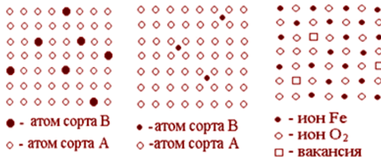
Рисунок 43 – Различные типы твердых растворов: а – твердый раствор замещения, б – твердый раствор внедрения, в – твердый раствор вычитания
