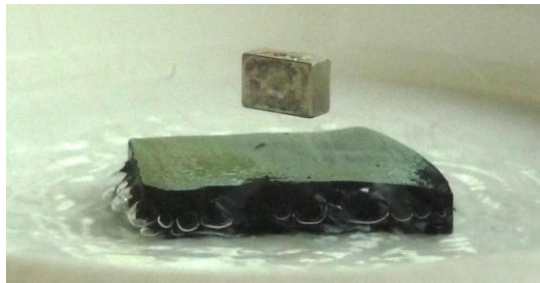
Рисунок 129 – Левитация магнита над ВТСП-керамикой
