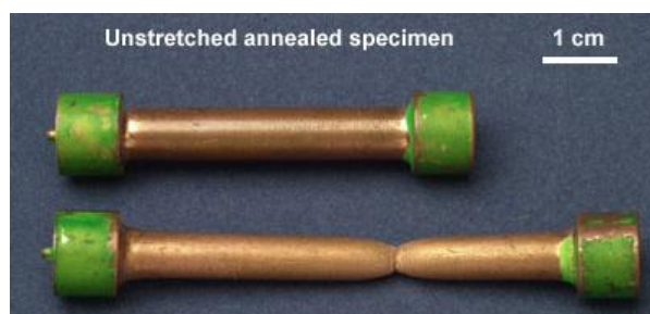
Рисунок 76 – Внешний вид образцов до растяжения (вверху) и после растяжения (внизу, видна шейка)
