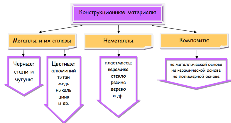
Рисунок 74 – Классификация конструкционных материалов
