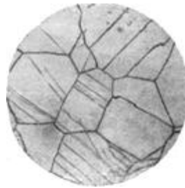
Рисунок 77 – Микроструктура хромоникелевой нержавеющей стали (травление царской водкой); зерна аустенита. \times 500
