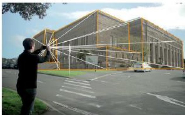
Сурет 3- Топографиялық пландар мен жербеттік лазерлік сканерлеу мәліметтерін бірге қолдану арқылы құрылған үшөлшемді модел
