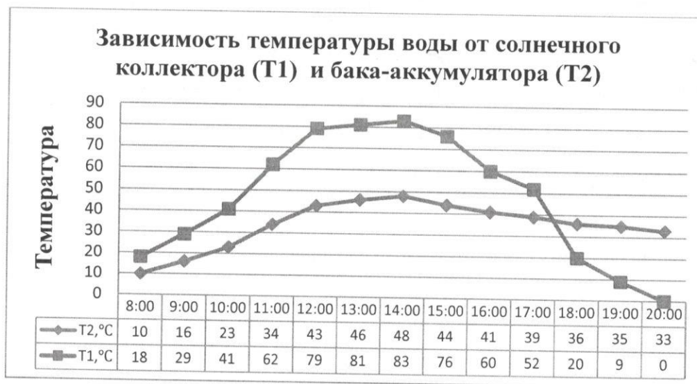
Рисунок 4. Зависимость температуры воды от солнечного коллектора и бака-аккумулятора
