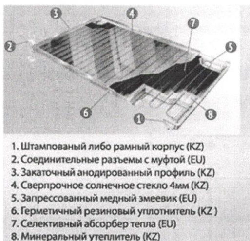
Рисунок 1. Солнечный коллектор в разрезе
