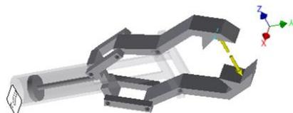
Рис.1 - схема механизма схвата и 3D модель
